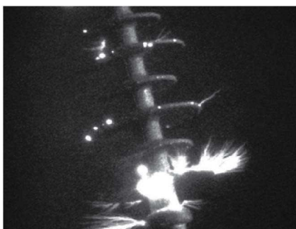
شکل ۴: نمونه‌ای از تخلیه الکتریکی در تماس با مواد چترک
